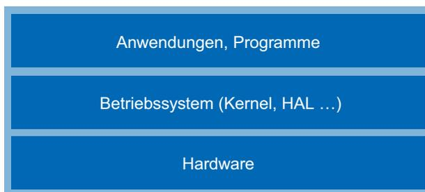
**Abb. 2.1:** Aufbau Betriebssystem
